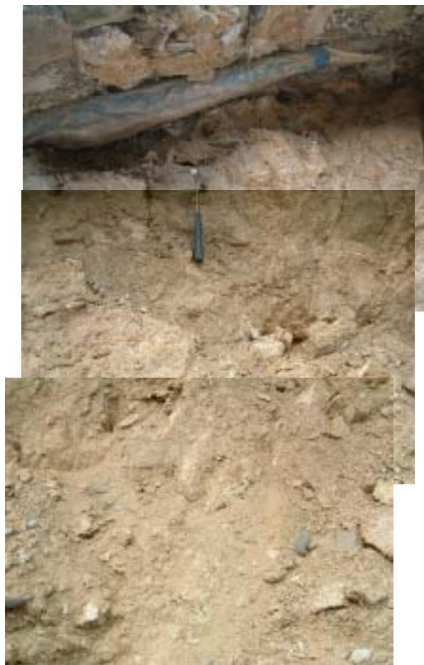
写真-2 同露頭のクローズアップ：階段直下に玉石層（多分自然堆積）が見られ、その直ぐ下にはマサの2次堆積はほとんど見られず、花崗岩の風化層が連続している。
